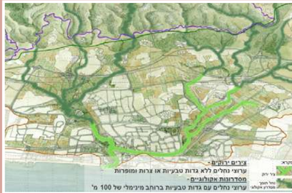
תרשים ה-2 כירסום גדות נחל מודיעים וסכמה כללית של הנחלים והערוצים עם גדות טבעיות וגדות מופרות
