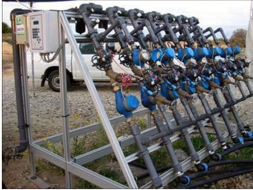
איור 3: מערכת לבקרת זרימה ופיזור קולחים לבריכות האגנים הירוקים בשפד"ן. המערכת כוללת 7 עמדות המזרימות קולחים ל 7 טיפולים. בכל עמדה צנרת כפולה המיועדת להזרמה של קולחים בספיקה גבוהה או נמוכה. על פני הצנרת מדי ספיקה ובצדה בקרים (Gavish) לקביעת דפוס הזרימה.
