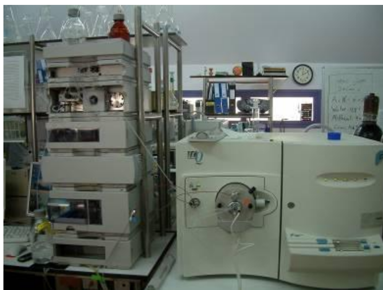
איור 10: מתקן HPLC (Agilent 1100) ו-MS (Finnigan, LCQ) במעבדה להידרו-כימיה באוניברסיטת תל-אביב.
